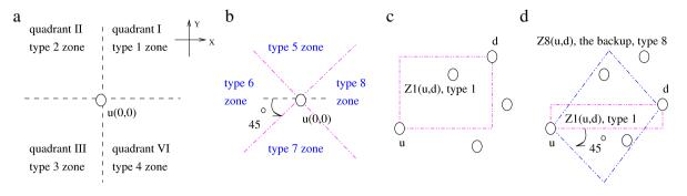
**Fig. 2.** (a)  $Q_1(u)$ ,  $Q_2(u)$ ,  $Q_3(u)$ , and  $Q_4(u)$ . (b)  $Q_5(u)$ ,  $Q_6(u)$ ,  $Q_7(u)$ , and  $Q_8(u)$ . (c) Request zone. (d) Backup zone.
